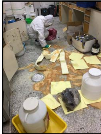
推腐靈中和劑鋪面 後再以吸收棉吸附
