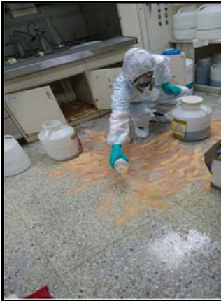
現場應變以推腐靈 中和劑鋪面
