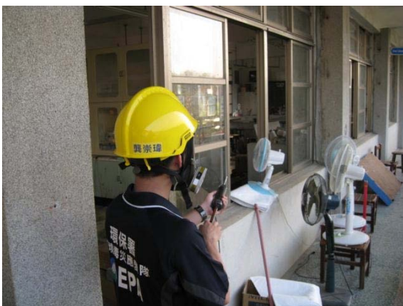
甲醛檢知管現場檢測
