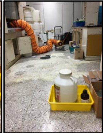
處理後使用移動式 緊急抽排風機經排 氣櫃，持續通風排 氣超過三天。
